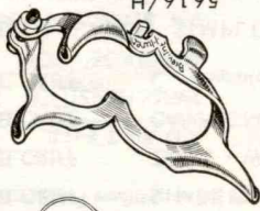
5616/G GELENKSCHELLE zur leichteren Übertragung des Schaltriffes
